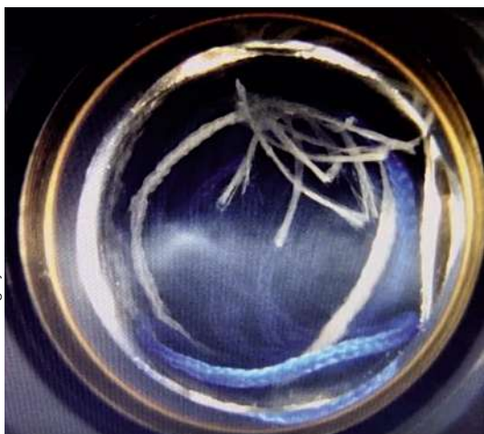
Opalescence supercritique (brouillard blanchâtre) apparaissant lors du changement de phase du gaz carbonique utilisé pour la stérilisation de textile implantable.
