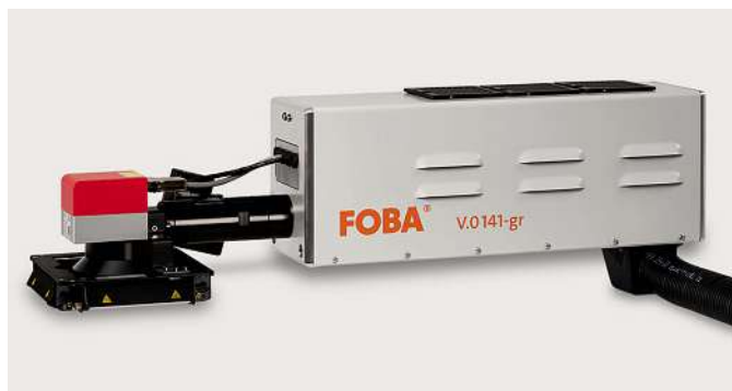
La combinaison d'une puissance laser assez élevée et d'une source au vanadate élargit le champ d'application du nouveau marqueur Foba et augmente sa vitesse de marquage.
