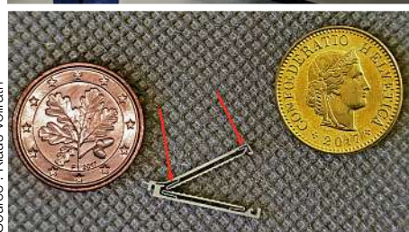
Composant d'implant fabriqué par micro-découpe au jet d'eau à partir d'une tôle en alliage de nitinol de 1,15 mm d'épaisseur
