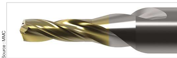
Sur ces nouveaux forets, le dégagement de goujure est réalisé dans la partie conique, ce qui améliore sensiblement l'évacuation des copeaux, comparé à un épaulement entre la partie taillée et la queue.
